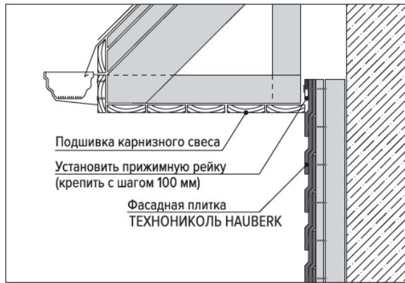
Рис.9.1 Монтаж верхнего ряда под карнизным свесом. Вариант 1
